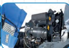
Puissant moteur diesel ISEKI 1 123 cm<sup>3</sup>
