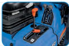
Commandes ergonomiques hydrauliques du bac, cruise control, frein de parking
