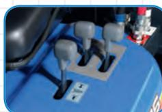
Leviers de commande hydrauliques et connecteurs hydrauliques push pull
