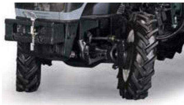
› Les deux versions sont équipées de l'essieu avant Carraro modèle 20.09 avec angle de braquage de 55°.
