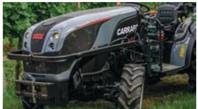
› Les deux versions sont équipées d'essieux avant Carraro. Le VLB de l'essieu 20.09 avec angle de braquage de 55° et le FB de l'essieu 20.16 et angle de braquage de 52°.
