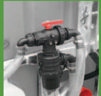
Filtre d'aspiration avec valve de fermeture 3 voies pour circuit de lavage rapide des résidus chimiques
