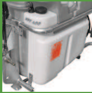
Circuit de lavage rapide des résidus chimiques
