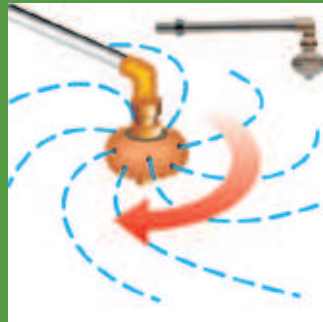
Jet de lavage dans intérieur de la cuve
